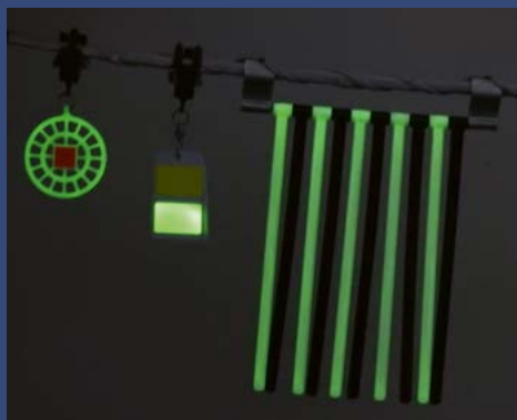
Obr. 5 Rôzne typy odkloňovacích prvkov a ich viditeľnosť počas dňa a noci. Výber konkrétneho prvku závisí nielen od druhovej skladby vtákov v okolí vedenia, ale aj technických možností inštalácie a typu vedenia. (M. G.)
